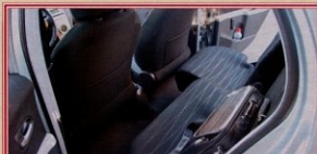
Задний диван разделен на две части в соотношении 60/40. Каждый половинка имеет продольную регулировку.
